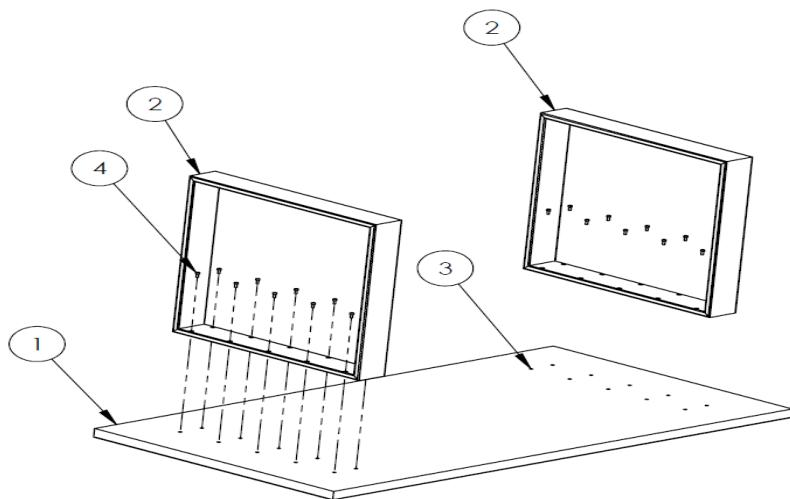
**PL.** Używając dostarczonego kluczyka oraz śrub M6x16 (20szt) (poz 4) przykręcić nogi. **EN.** Using the included wrench and M6x16 screws (20 pcs) (item 4) screw the legs. **DE.** Befestigen Sie die Beine mit dem mitgelieferten Schraubenschlüssel und den Schrauben (Pos. 4). **CZ.** Pomocí dodaného klíče a šroubů M6x16 (20 ks) (poz. 4) přišroubujte nohy . **SV.** Pomocou dodaného kľúča a skrutiek M6x16 (20 ks) (poz. 4) priskrutkujte nohy.
