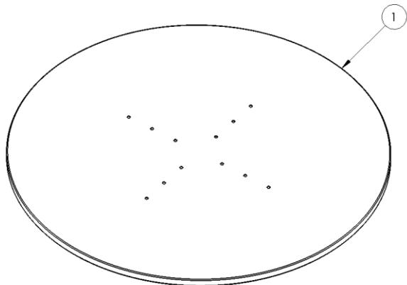
**PL.** Przygotowaną wcześniej nogę połączyć z blatem (poz 1) przy użyciu śrub M6x16 (poz 6). **EN.** Connect the previously prepared leg with the table top (item 1) using M6x16 screws (item 6). **DE.** Verbinden Sie das zuvor vorbereitete Bein mit M6x16-Schrauben (Pos. 6) mit der Tischplatte (Pos. 1). **CZ.** Připojte dříve připravenou nohu k desce stolu (poz. 1) pomocí šroubů M6x16 (poz. 6). **SV.** Pripojte predtým pripravenú nohu k doske stola (pol. 1) pomocou skrutiek M6x16 (pol. 6).
