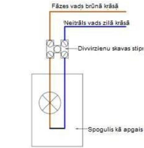
4. attēls Elektrisko vadu savienošanas shēma ar savienotāju
